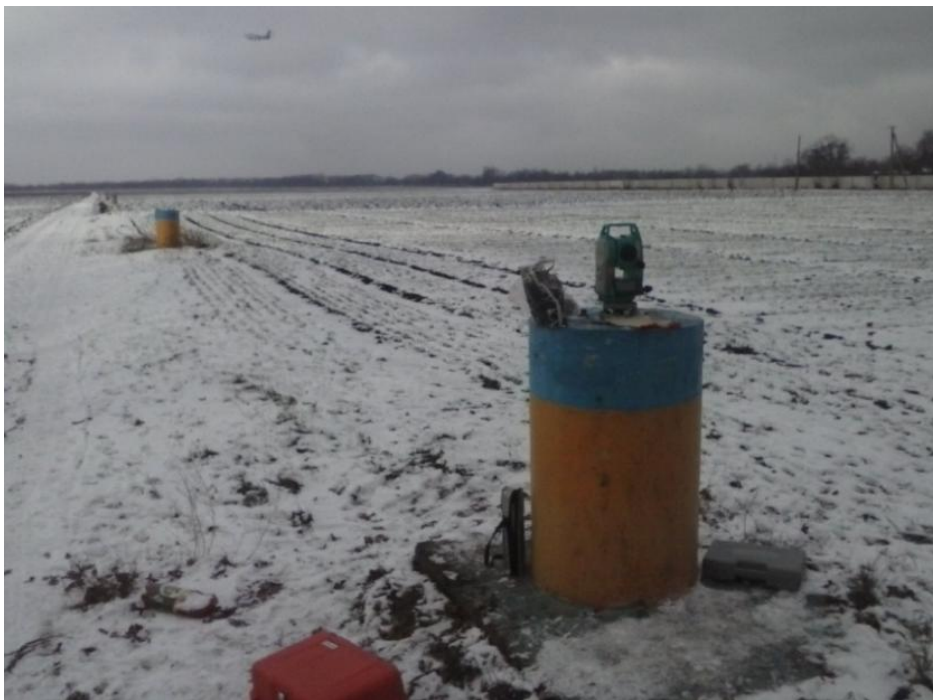
Рисунок 9 – Повірка віддалемірної частини тахеометра на Одеському еталонному геодезичному полігоні
