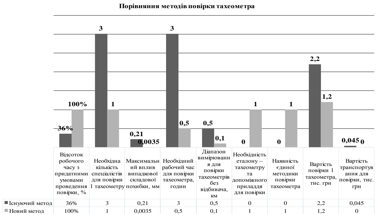
Рисунок 8 – Гістограма порівняння існуючого та нового методів повірки тахеометрів
