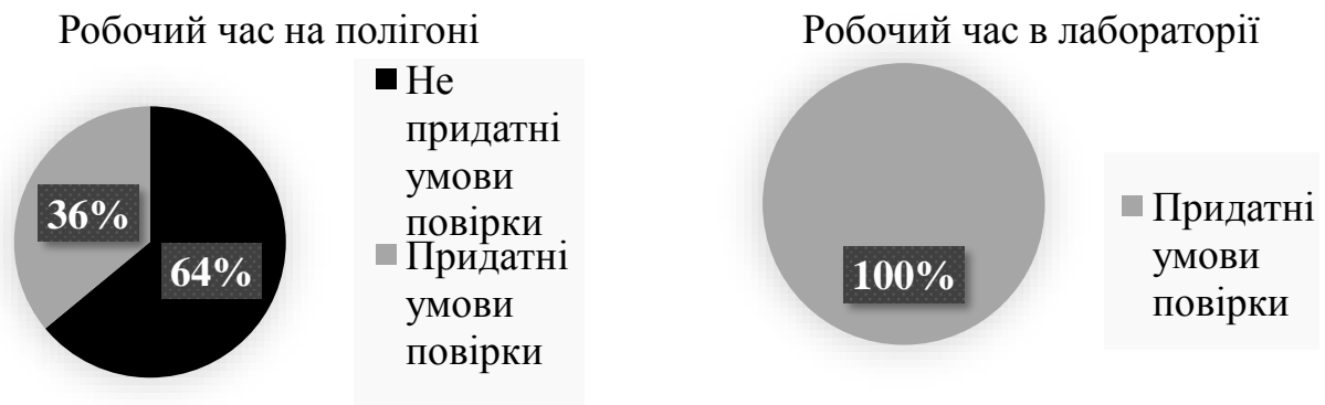
Рисунок 7 – Порівняння відсотку робочого часу з придатними умовами проведення повірки на полігоні та в лабораторії
