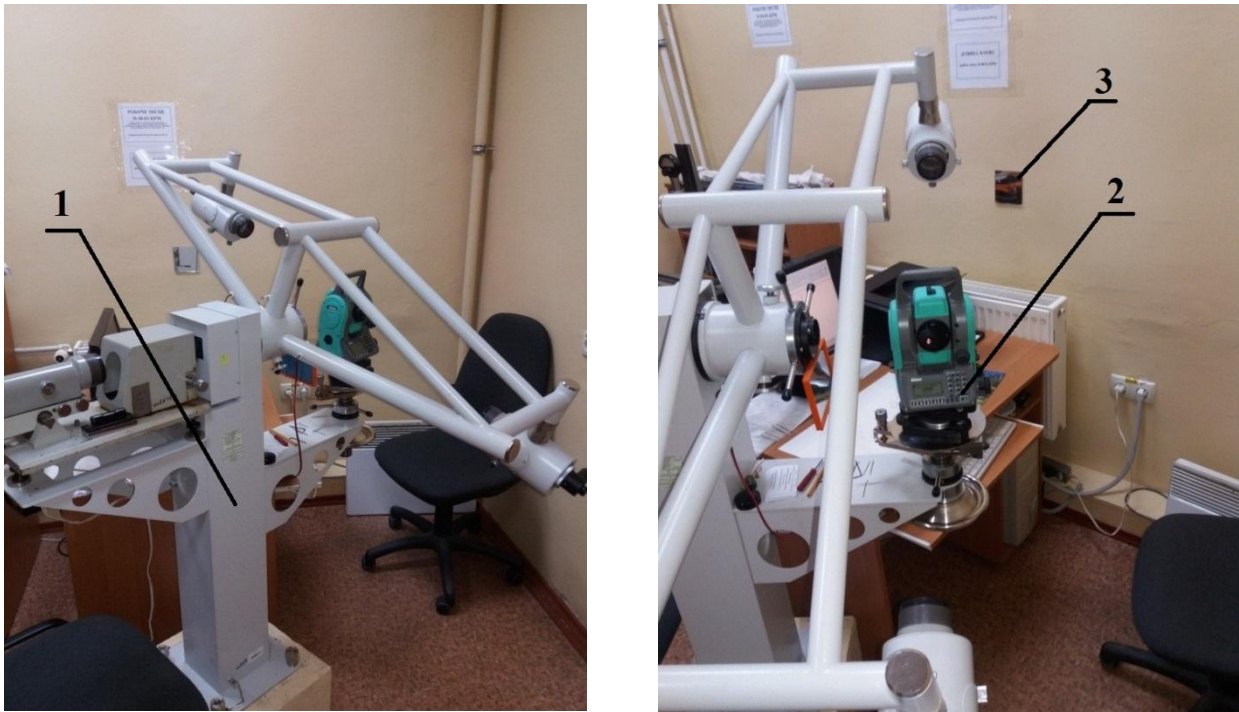
Рисунок 10 – Повірка кутомірної та віддалемірної частини тахеометра в лабораторних умовах: 1 – автоколімаційна установка, 2 – тахеометр, 3 – дзеркало.
